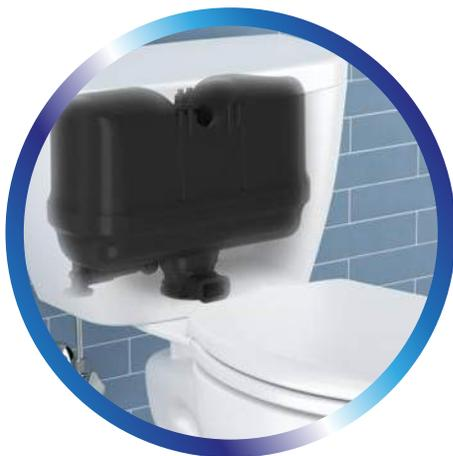
Dentro de los inodoros de alta eficiencia, los inodoros de descarga con presión asistida son los más reconocidos. Estos van más allá de la norma de la EPA y pretende usar alrededor de 1.3 GPF y hasta menos. La tecnología se basa en utilizar aire comprimido, el cual se obtiene de la compresión que genera el llenado de la cisterna en un taque más reducido que el del inodoro original; permitiendo un aumento en la velocidad de descarga.
